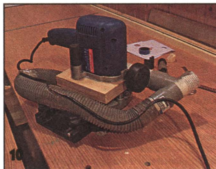
Коробка и воздуховод, тройник и шланг основной воздушной магистрали установлены. Примыкания герметизированы силиконом. Инструмент готов к чистой и точной работе.
