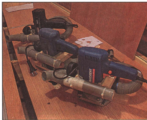
«Парк» доработанных фрезеров, каждый из которых выполняет только свою операцию, и делает её «на отлично».
