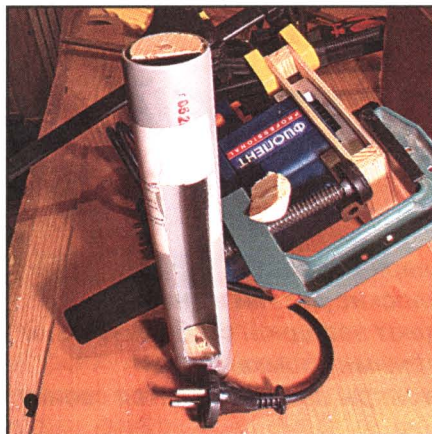
С другого конца сечение воздуховода уменьшено вставкой обтекаемой формы, чтобы согласовать расход воздуха основного и охлаждающего двигателя потоков.
