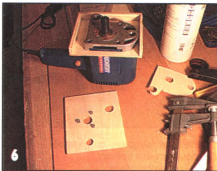
Изготовление деревянной коробки для отбора охлаждающего воздуха и направления его в пылесос
